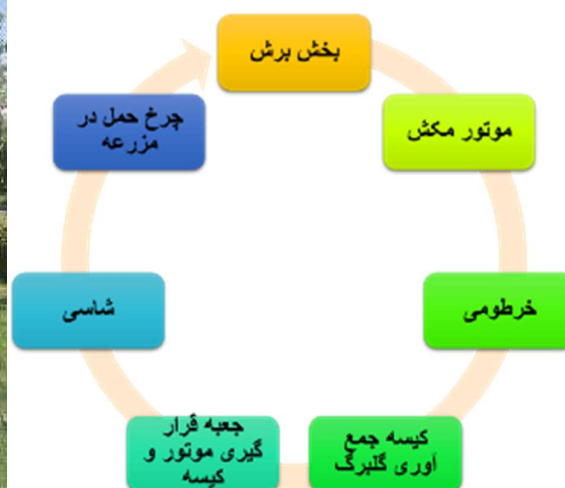
شکل ۵۲- اجزای دستگاه برداشت گلچه‌های گلرنگ
