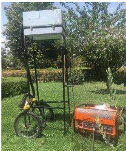
شکل ۵۲- اجزای دستگاه برداشت گلچه‌های گلرنگ
