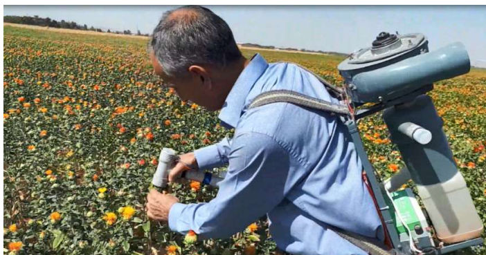
شکل ۵۰- عملیات برداشت گلچه‌های گلرنگ در مزرعه توسط ماشین پشته‌ی برقی اصلاح‌شده
