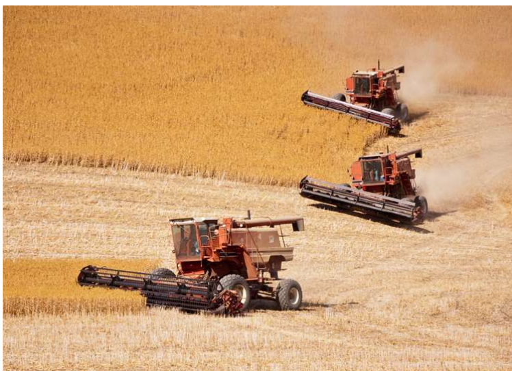
شکل ۴۸- برداشت قوزه (دانه) گلرنگ توسط کمباین غلات
